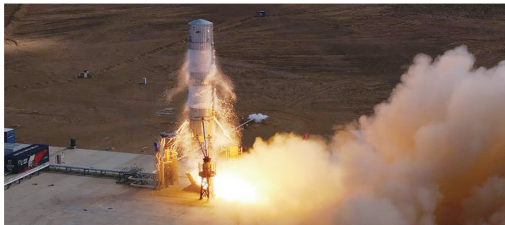
朱雀三号VTVL-1可重复使用垂直起降回收试验箭
