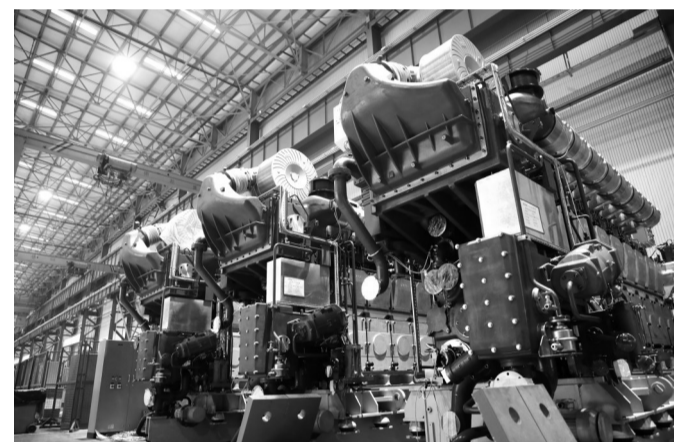
中船镇柴自主研发的缸径320毫米发动机
