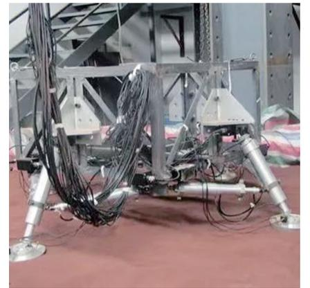
嫦娥三号探测器着陆缓冲装置地面实验缩比样机 图片来源:学校官微
