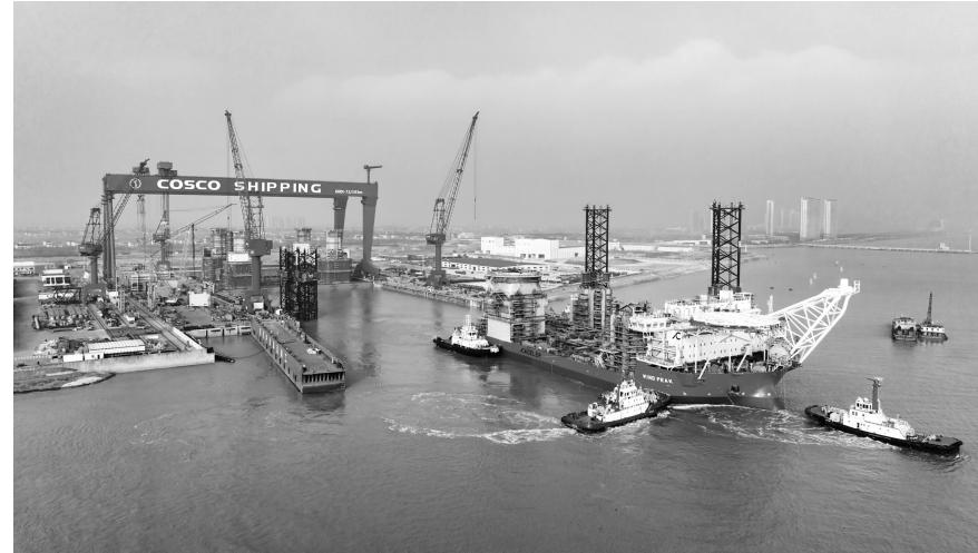
1月3日,在南通海事局的精心维护下,启东中远海运海工N1063自升式风电安装船安全下水。该船建成后,将成为全球技术规格最高、最先进和最环保的海上风电安装船。据了解,N1063风电安装船是丹麦船东定制的4艘全新一代风电安装船的首制船。该系列风电安装船拥有5600平方米的甲板面积,有效载荷超过17600吨,使用混合动力,可以运输并安装7套完整的15MW风机或5套20MW以上的风机。
