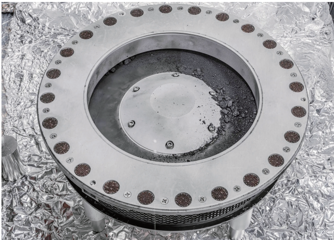
奥西里斯-REx样品收集器的外部视图。来自小行星贝努的样本材料可以在中间偏右的位置看到。科学家在对这种物质的初步分析中发现了碳和水的证据。大部分样本位于内部 图片来源: NASA
