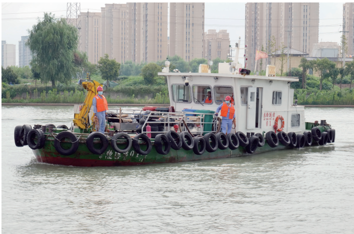
京杭运河扬州段上的船舶污染物接收船
