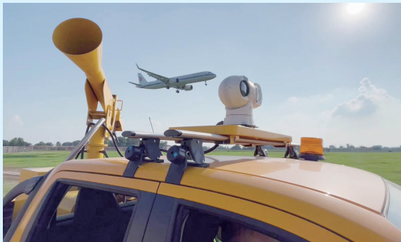
驱鸟车车顶搭载的热成像仪和车头安装的雷音炮
