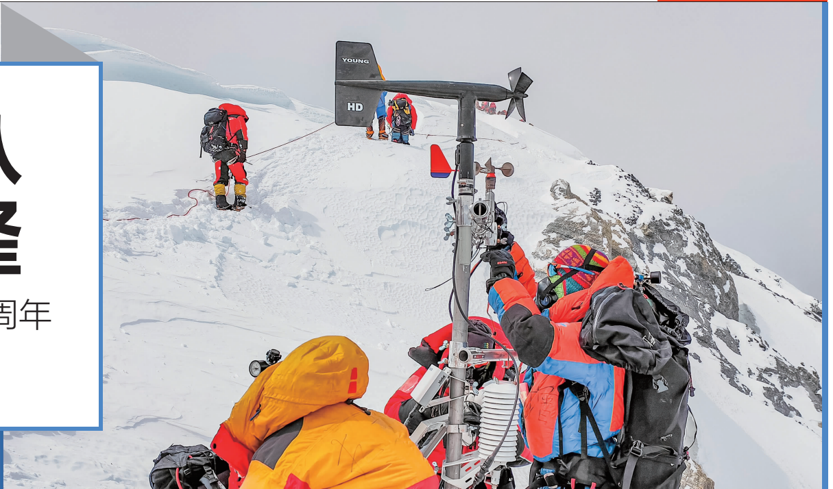
科考队员在海拔约8830米处维护升级自动气象站 新华社发
