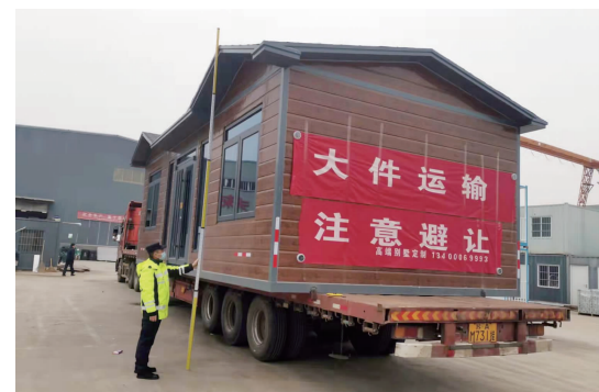
大件运输勘验 江苏省交通运输厅供图
