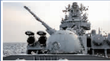
“莫斯科”号巡洋舰“AK-130”多用途双管舰炮和“堡垒”导弹发射装置 资料图(新华社发)
