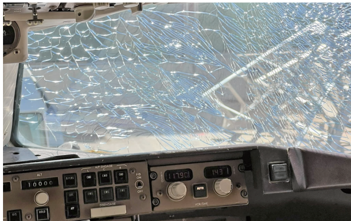
机上乘客在社交媒体上分享的照片显示，驾驶舱风挡出现了数十处裂缝，但并未从框架上脱落 据红星新闻
