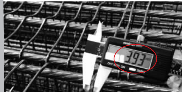
一直径400mm桩型的螺旋箍筋，直径小于国标规定的4mm
