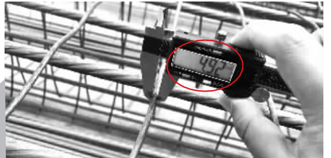
一直径500mm桩型的螺旋箍筋，直径小于国标规定的5mm
