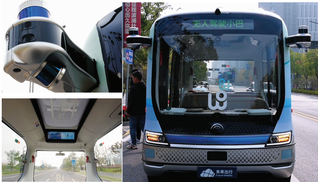
自动驾驶小巴没有方向盘,车头安装了高清摄像头
