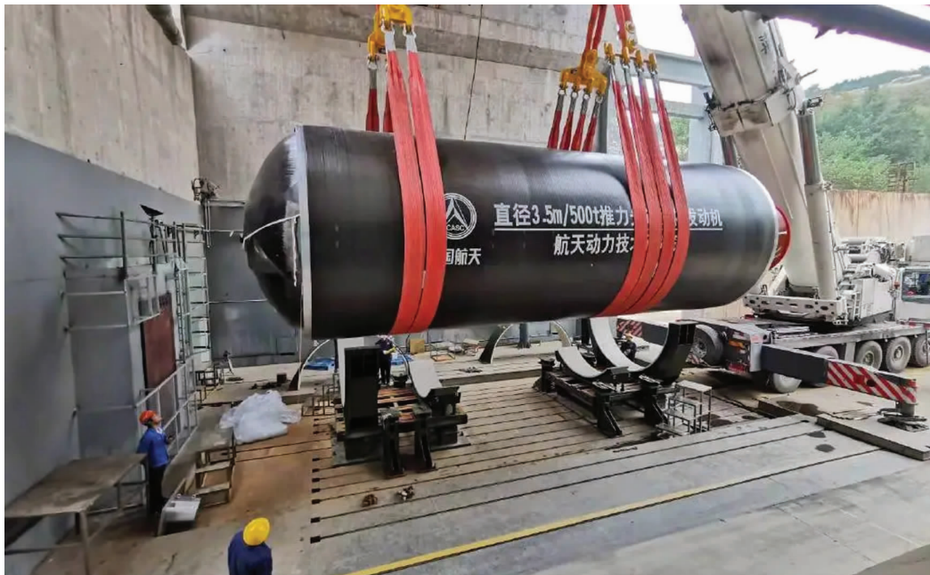
我国自主研发、推力达500吨的整体式固体火箭发动机 据新华社微博
