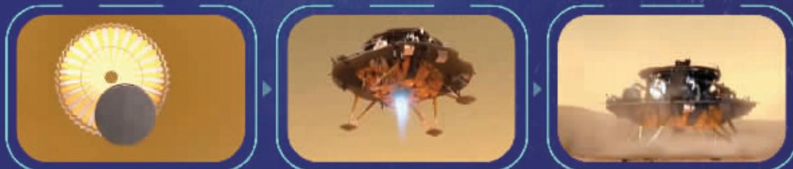
使用“减速伞+缓冲发动机反推+着陆腿方式”着陆(示意图)
