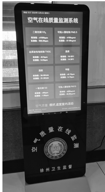
室内空气质量监测系统
