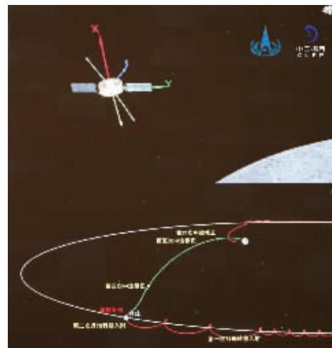
嫦娥五号探测器月地转移轨道示意图 据央视
