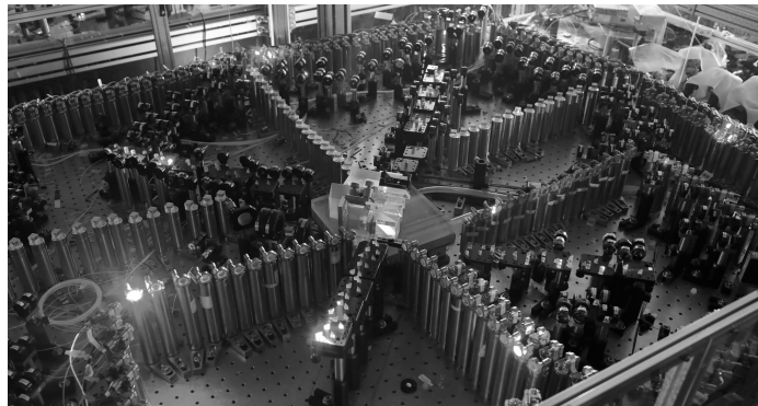
这是量子干涉实物图:左下方为输入光学部分,右下方为锁相光路,上方共输出100个光学模式,分别通过低损耗单模光纤与100超导单光子探测器连接 新华社发
