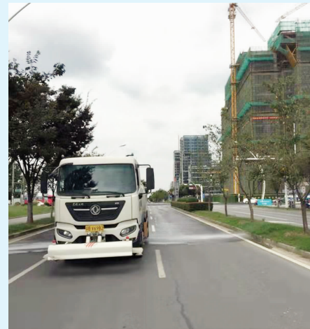
全天巡回保洁,洒水车和扫地车对路面进行降尘处置
