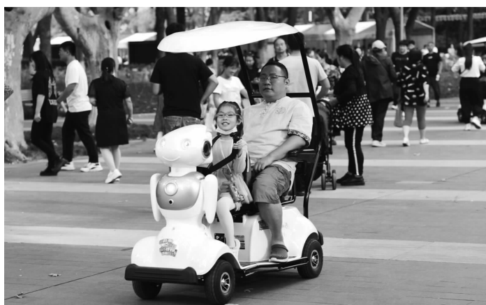
伴游机器人外部结构有遮阳伞、表情灯、状态指示灯、亲子座椅等 通讯员供图
