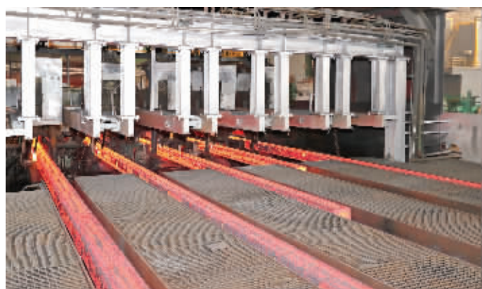
中天钢铁电炉炼钢厂正在采用世界首创的脉冲磁致振荡—电磁搅拌组合调控高均质化矩形坯连铸技术进行生产 陈明 摄
