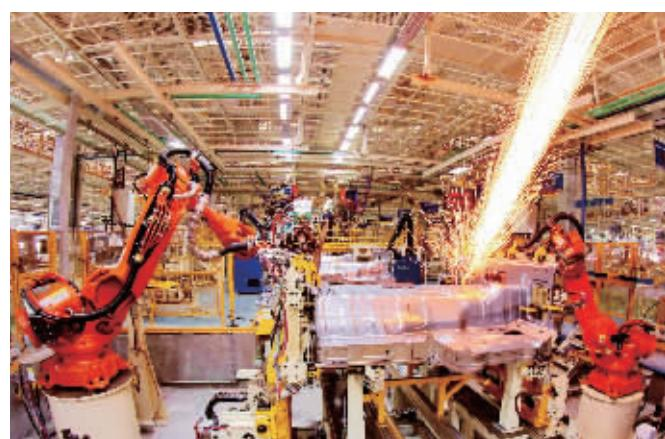
徐工汽车智能化精密焊接机器人
