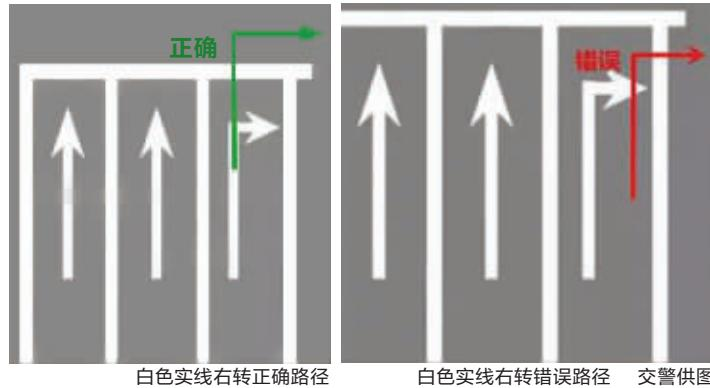
白色实线是路面常见的标志标线。划于路段中时,用以分隔同向行驶的机动车和非机动车,或指示车道的边缘;划于路口时,用作导向车道线或停止线,或用以引导车辆行驶轨迹;划为停车位标线时,指示收费停车位。
