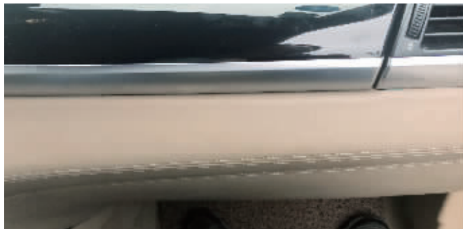
上图:宝马车头损伤严重 下图:副驾驶位气囊重新安装后没完全到位
