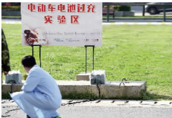
在过充实验区,过充的电池产生氢气,致使包裹电池的塑料袋爆炸
