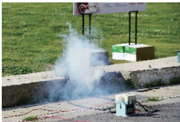
在电动车电池短路实验区,电池短路后冒出白烟
