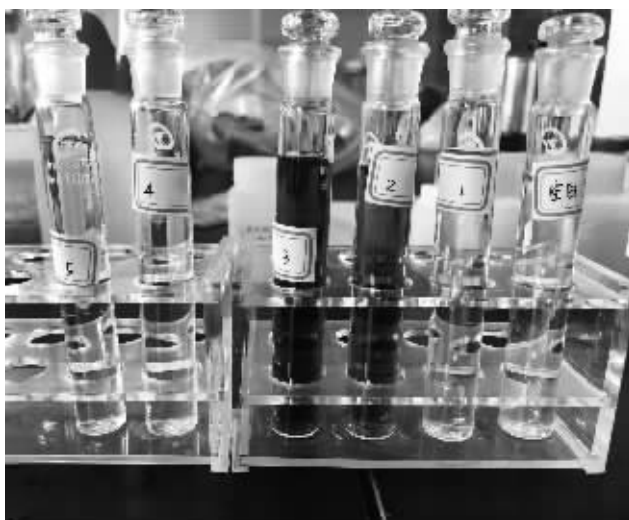
在二氧化硫含量实验中,2号和3号试管的颜色明显与其他试管不同
