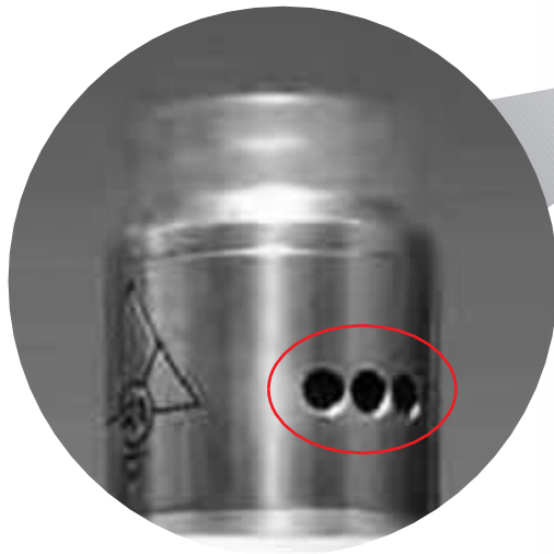
这款电子烟外观设计得很漂亮,对着顶部烟嘴吸,颈部3个洞是进气用的
