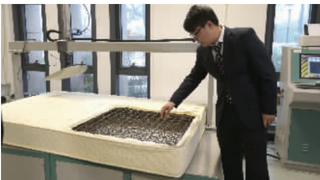
抽检的弹簧床垫在做耐久性测试
