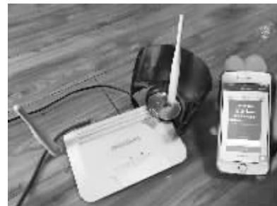
装上易拉罐后,平均下载速度为2.3MB/s
