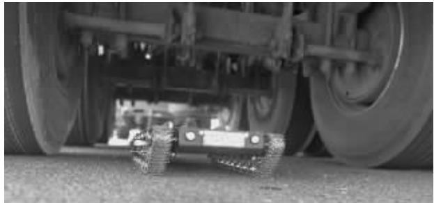
智能底盘探测仪检测大型车辆底盘上是否携带危险品
