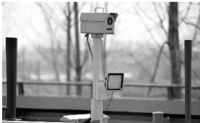
恶劣天气可变限速抓拍系统固定卡口抓拍设备
