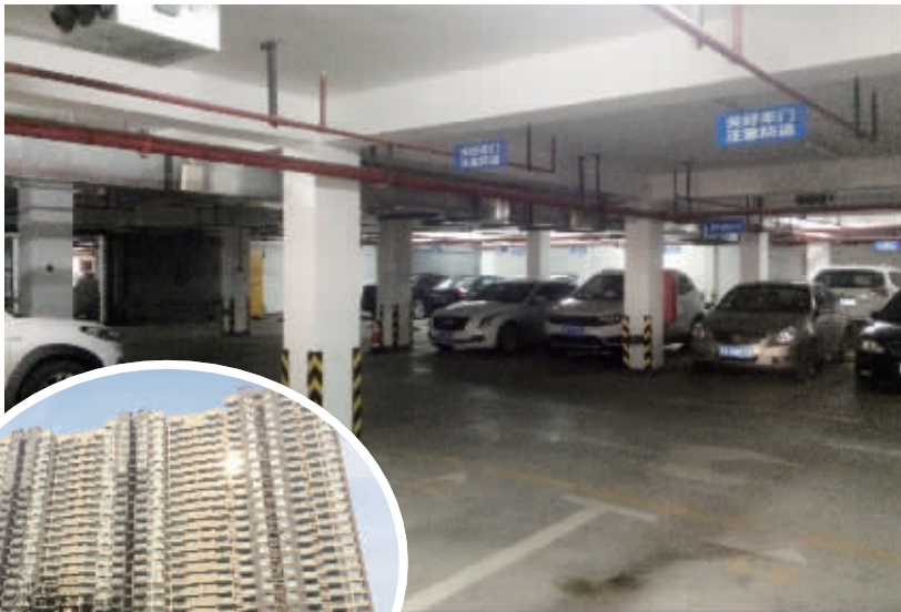
上图:地库高度不够设机械车位,导致车位不足 左图:无法交付的金泉泰来苑98幢
