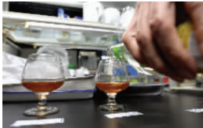
在一杯勾兑的假葡萄酒中滴入白醋,它的颜色与没有滴入白醋的假葡萄酒相比,也略微变浅
