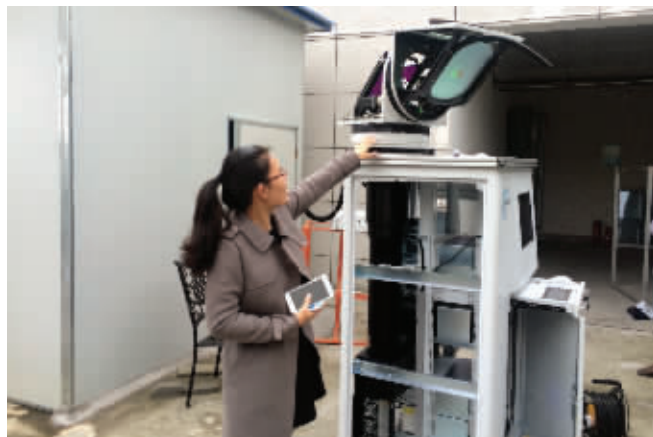
运用“大气颗粒物监测激光雷达”,就能监测雾霾
