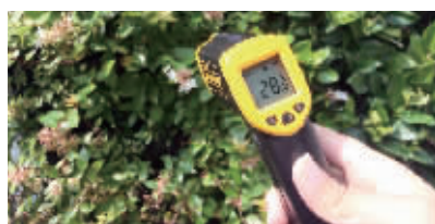
木屋东面墙室外温度28.6℃
