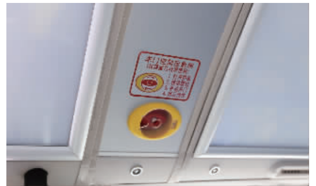
紧急情况下,转动车门控制应急阀旋钮,可手动开门
