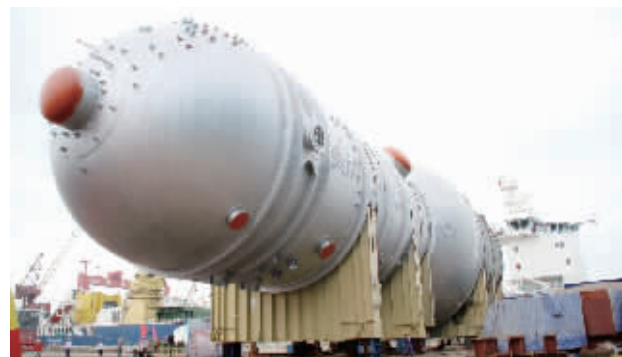
直径18米的大型炼油设备
