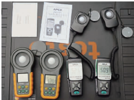
两款APEX照度计在同一稳定光源下,显示的数值不同
