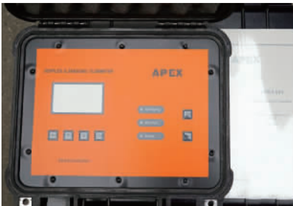
自称美国鼎翼公司生产的多普勒超声波流量计
