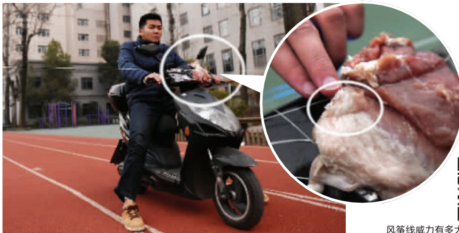
电动车前固定住肉,以30公里的时速撞上风筝线,肉上面有明显痕迹
