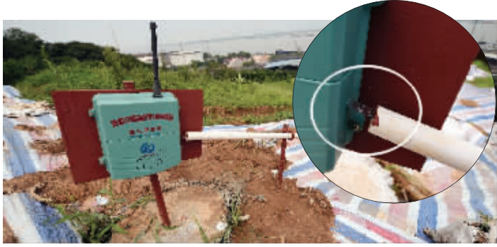
安装在山坡上的地质灾害无线预警器,小图圈画处是一个标尺,设备采集到地面移动达到5毫米,就把信号发射到预警主机里
