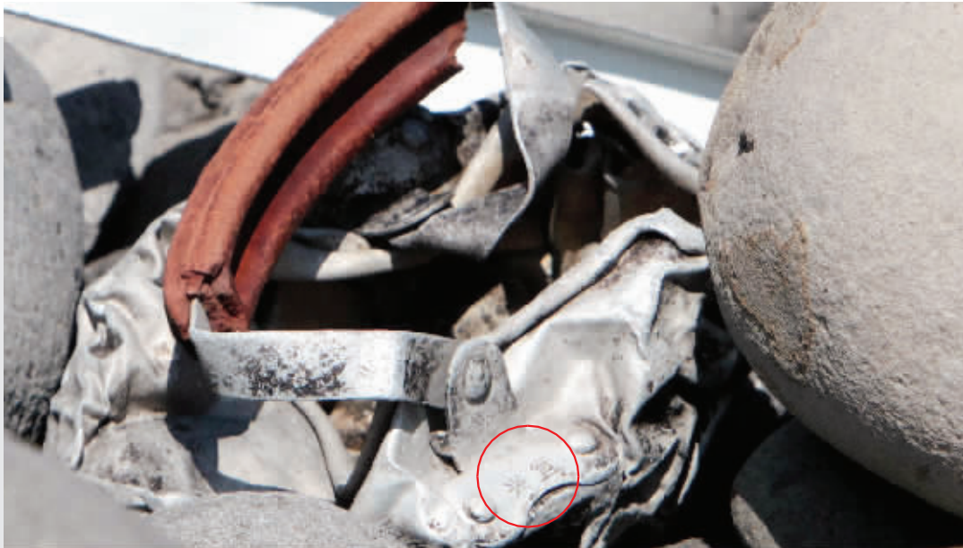
留尼汪海边发现的金属物件上有“兴”“宜”二字,最终被确认不属于飞机残骸,而是来自家用梯子
