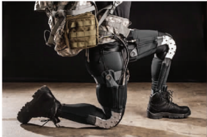
“勇士织衣”作战服功率小于100瓦,不到9千克重,电池重约4.5千克,在不充电情况下可持续工作24小时,士兵背负45千克重物、以1.25米/秒的速度在平地上行走时,可以减少25%的代谢消耗。
