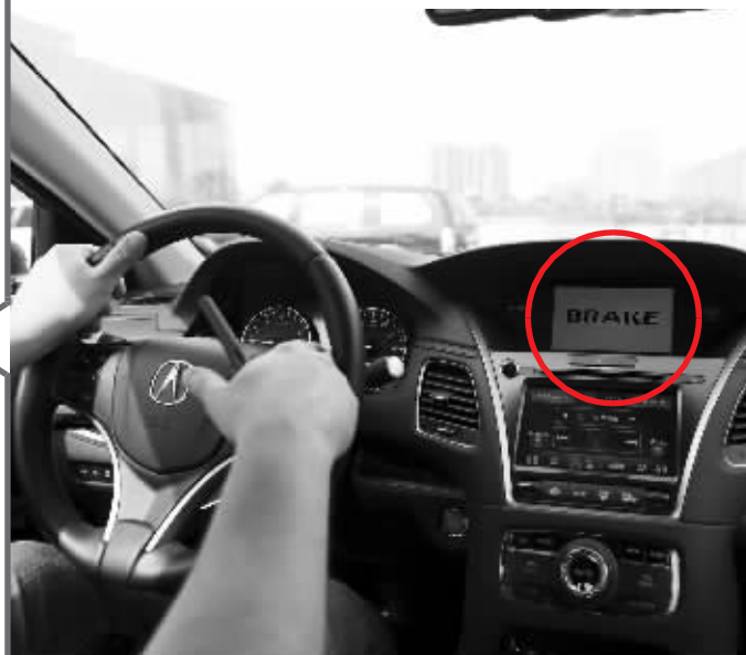
在遇到行人横穿马路时,车载屏幕会显示警告,并且发出警告声音
