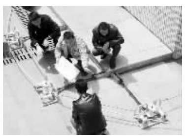
4月22日,区供电公司运维检修部配电网电缆班班长殷远东组织班组成员研制电缆转角导向滑车装置,以减少电缆转向磨损与难度。 任飞
