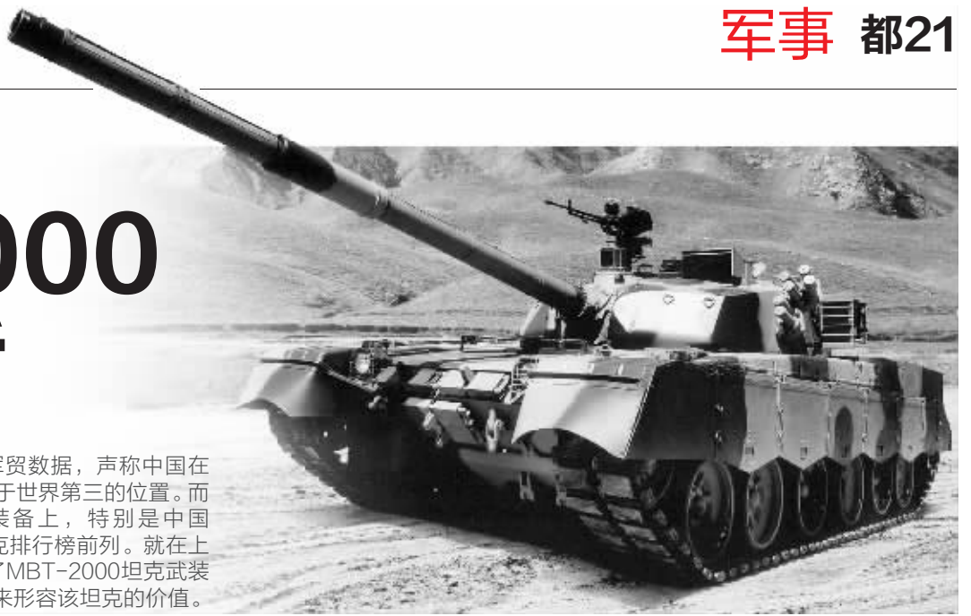
MBT-2000配备乌克兰出品的6TD-2二冲程柴油机
