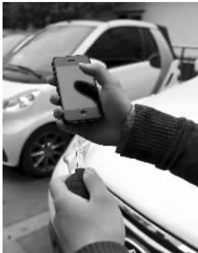
两部手机处于接通状态,遥控钥匙靠近其中一部手机,试图传递信号
