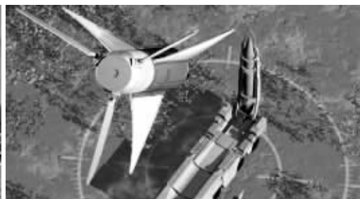
“短柄斧”航空制导炸弹,重量不足3千克,但仍采用半主动激光精确制导
