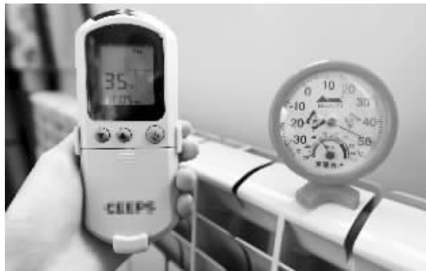
▲家用电暖气片 ▲遥控器设置温度为35℃,可电暖气片周围的温度已接近50℃ 现代快报记者 邱稚真 摄
