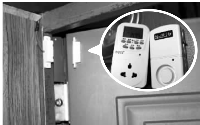
大图:两个部件分离时,门磁报警器就会报警 小图:报警器还带有遥控器,能防止误报
