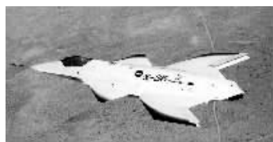
没有机尾的飞机“麦克唐纳·道格拉斯 X-36”飞机,它是一架制造于1997年的模型样机,用于测试无机尾飞机的飞行能力,通过地面远程控制飞行
