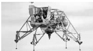
这架登月研究机是作为阿波罗登月计划的一部分,在1964年由美国贝尔航空系统公司建造,它由一个喷气式引擎提供动力,实现垂直升降
