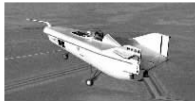
没有机翼的飞机“M2-F1”,这种飞机依靠机身的特殊设计提供气动升力
