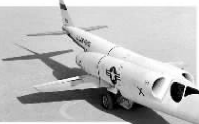
这架名为“道格拉斯 X-3 短剑”的实验喷气式飞机制造于1952年,特点是机身狭窄、机翼短小、机头是又尖又长的锥形,它是当时飞行过程中受到空气阻力最小的飞机
