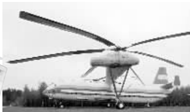
这架由俄罗斯制造的“米尔 V-12”是世界上最大的直升机,总长度为28米,它的横向机翼上还装有一对旋翼
