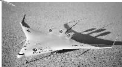
“X-48B”翼身融合飞机样机,它是传统飞机和飞翼设计的中间产物,是多用途、长距离、大容量军用运输飞机
